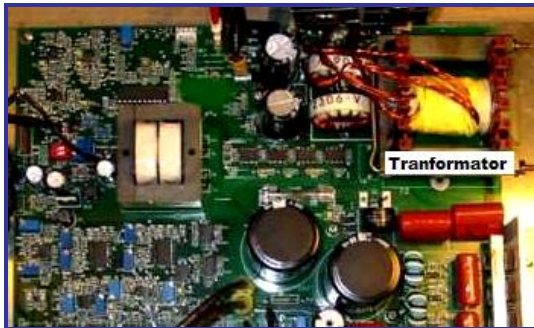
Gambar 5.10 Transformator pada Peralatan Elektronik
