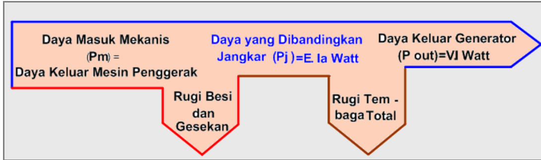
Gambar 5.79 Diagram Aliran Daya pada Generator Arus Searah
